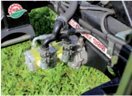
Hydraulikkomponenten und Untersetzungsgetriebe werden nach Kundenwunsch auf die Zapfwelldrehzahl des Traktors abgestimmt.
