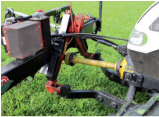
Eigene Ölversorgung der Mähantriebe mit Öltemperaturüberwachung und Ölkühler.
