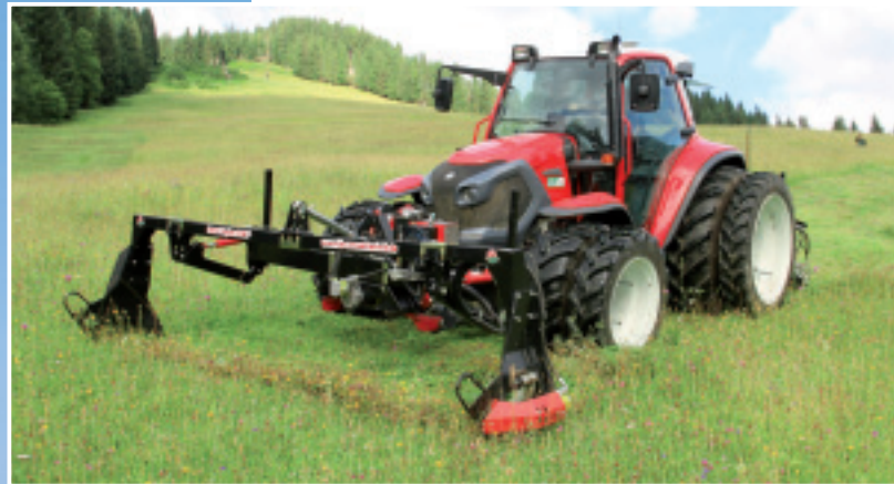
Doppelmesser-Mähkombination mit 9 m Arbeitsbreite: schlagkräftig mähen mit 2–3 Liter Diesel pro Hektar.
