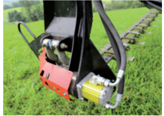
Hydraulikkomponenten und Untersetzungsgetriebe werden nach Kundenwunsch auf die Zapfwelldrehzahl des Traktors abgestimmt.
