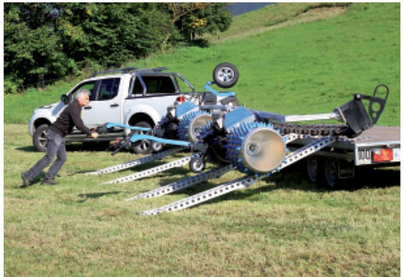
Transportlösung: Über vier Rampen lässt sich der Megamäher einfach auf- und abladen.
