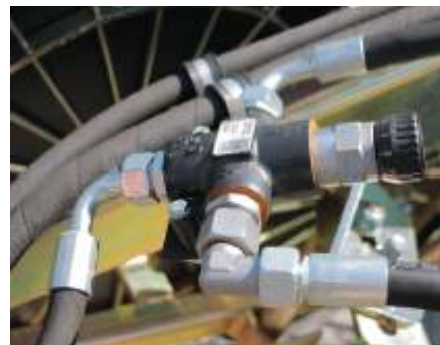
Dies ist die einfachste Lösung, um die Schwingzahl zu steuern. Hier direkt am Gerät angebracht, handelt es sich um eine unkomfortable Lösung, bei der zudem nach Gehör gefahren werden muss. Empfehlenswert ist daher die elektrische Verstellmöglichkeit via Terminal mit Anzeige der Schwingzahl.
