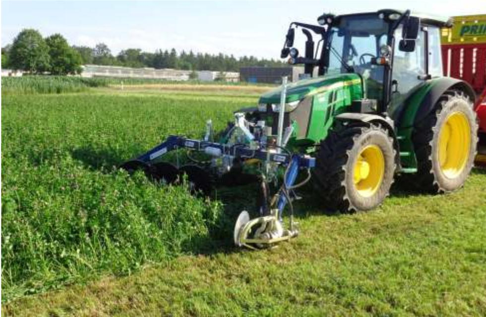
Doppelmessermähwerke ermöglichen den Einsatz kleiner und leichter Traktoren, z. B. hier bei der täglichen Grünfütterbergung. Es werden herstellerseitig auch Lösungen angeboten, um Frontmähwerke an Traktoren ohne Fronthubwerk betreiben zu können.
