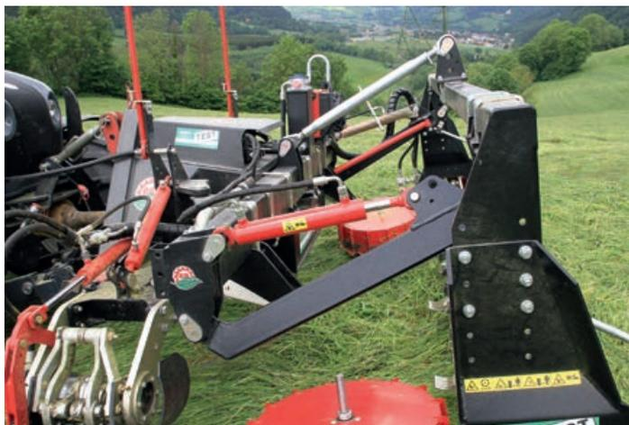
Alle Mähantriebe und Hydraulikzylinder werden von der bordeigenen Hydraulik mit Öltemperaturüberwachung und Ölkühler versorgt.
