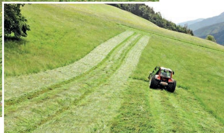
Der „Doppelmesser-Schmetterling“ ist um etwa zwei Drittel leichter als Rotationsmäherwerke und begnügt sich mit etwa einem Fünftel der Antriebsleistung.
