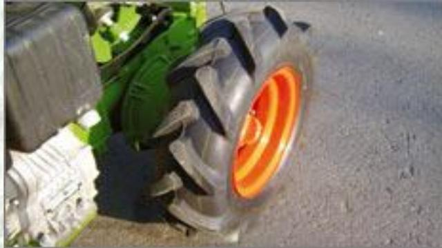
Neumáticos individuales, ejecución estándar de CaneThumper® con fines de uso en áreas con pendiente ligeras (ligeramente inclinadas) y llanas.
