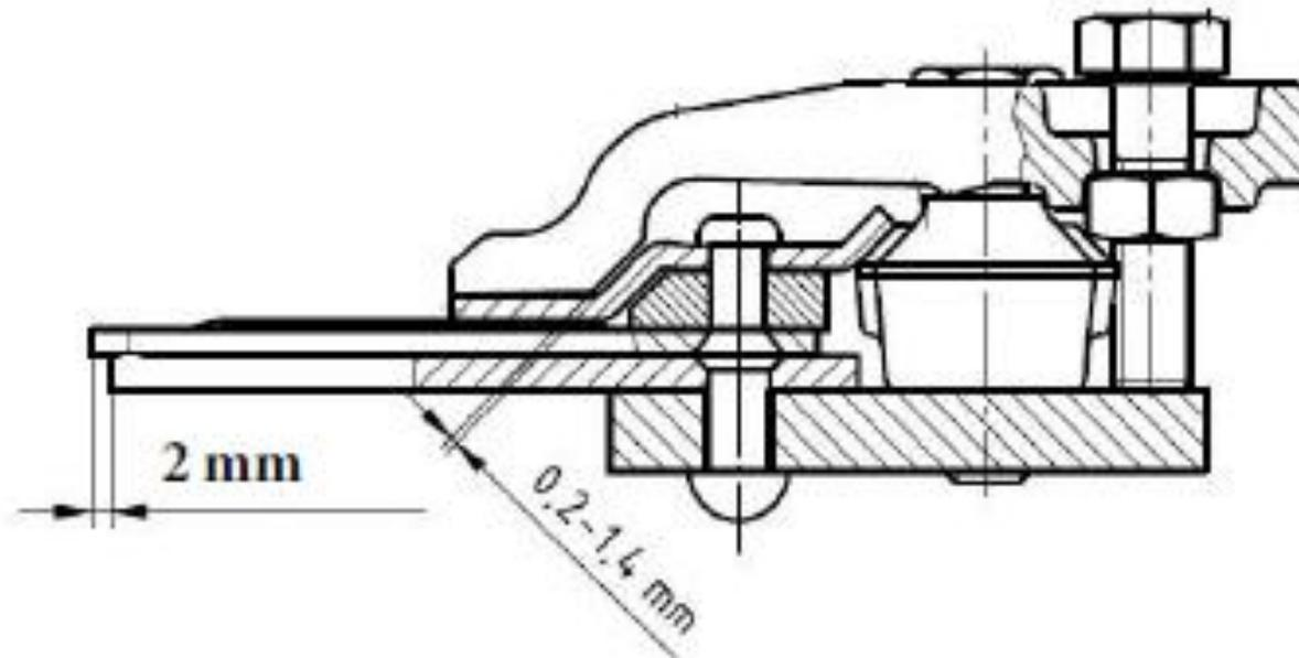
Messer auf einen Überstand von 2 mm einstellen und mittels Schraubzwingen o. Gripzangen fixieren.
